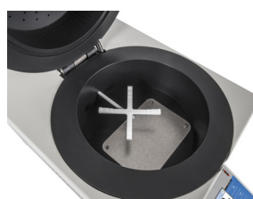
Specjalistyczna komora do pomiarów wilgotności
