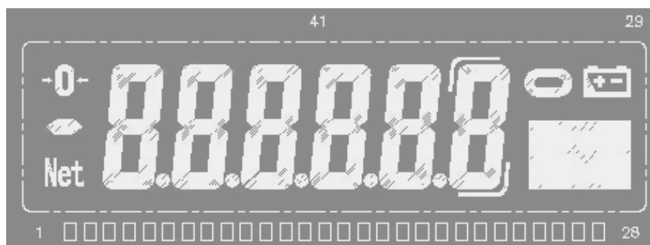
Si la capacité de la balance est de 600,0 g, le dernier chiffre sera le chiffre auxiliaire de l'affichage (un symbole indiquant le chiffre) :
