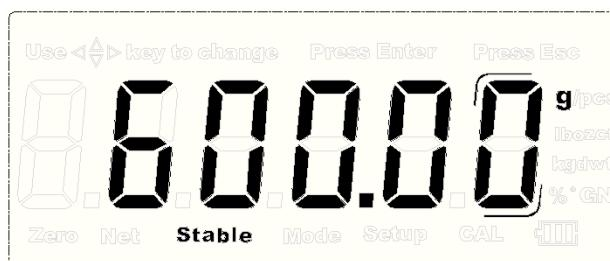
Si la capacité de la balance est de 300,00, 1200,0, 1500,0 et 3000,0 g, le dernier chiffre sera vide en mode de pesage normal uniquement si la touche EXT.D est actionnée pour agrandir l'affichage.
