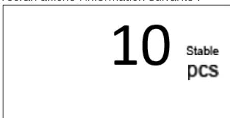
Enlevez les échantillons du plateau. L'opération d'échantillonnage est terminée. La balance peut ensuite être utilisée pour le comptage.
