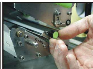
3. Kręć gałką regulacji czujnika, aż czujnik znajdzie się na przerwie między etykietami.
