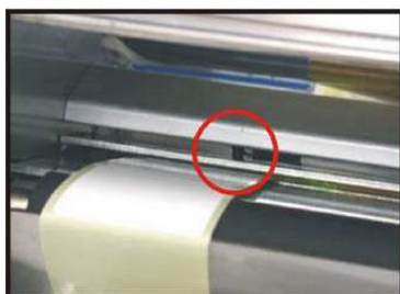
4. Po wypozycjonowaniu czujnika, zamknij głowicę.
