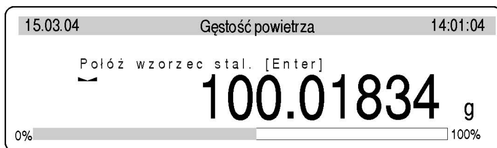
Rys. 28-9. Korekcja wyporności powietrza – wyznaczanie masy wzorca stalowego
