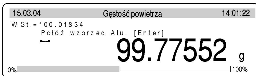
Rys. 28-10. Korekcja wyporności powietrza – wyznaczanie masy wzorca aluminiowego
