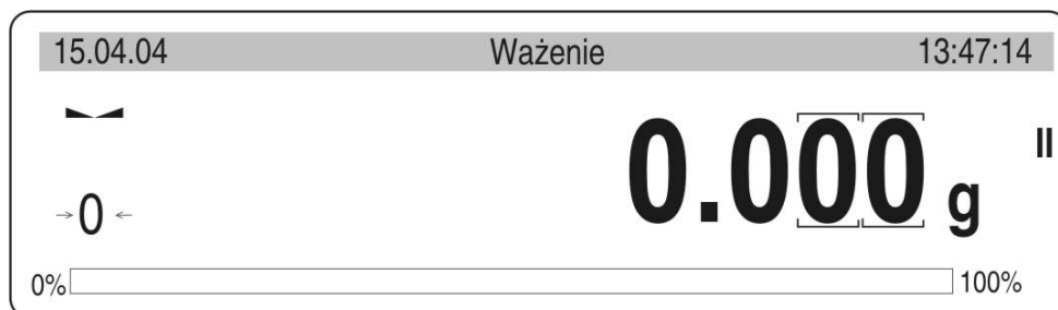
Rys. 13-2. Waga dwuzakresowa – wynik ważenia w II zakresie
