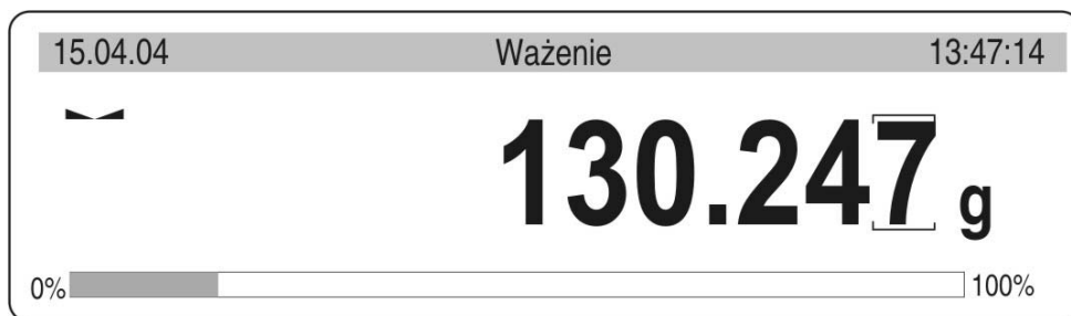
Rys. 12. Waga dwuzakresowa – wynik ważenia w I zakresie
