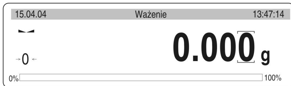
Rys. 13-3. Waga dwuzakresowa – wynik ważenia w I zakresie
